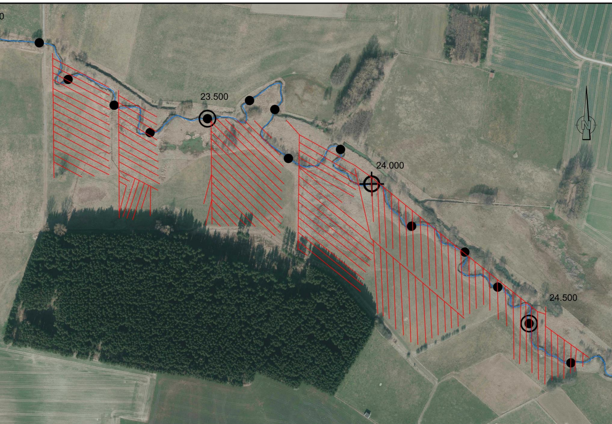
Ins Luftbild übertragener Lageplan aus den 80er Jahren der Drainageleitungen
